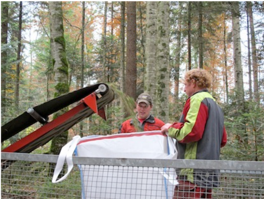
In kleine Stücke gehackt werden die Nadeln in grosse Säcke abgefüllt und in die Destillerie überführt.
